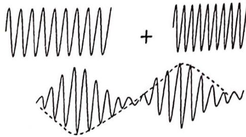
En la figura te muestro dos ondas de ese tipo, con una ligera diferencia en la frecuencia (observar que en un caso las ondas aparecen más ligeramente apretadas que en la otra), que al superponerse en cierto punto dan una resultante como la del último dibujo.
