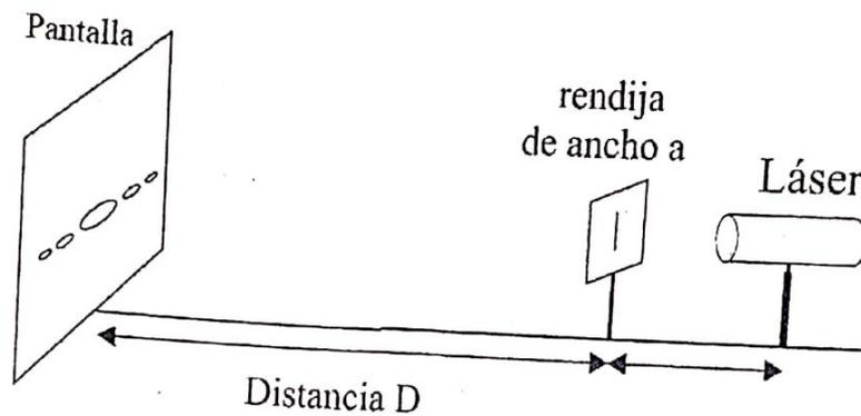
Sobre la pantalla se mide la posición del primer o segundo mínimo (puede medirse la distancia entre el segundo mínimo a cada lado, y dividirlo por 2 de manera de evitar la dificultad de localizar la posición central, centro de la zona oscura). La posición de los mínimos viene dada por:
