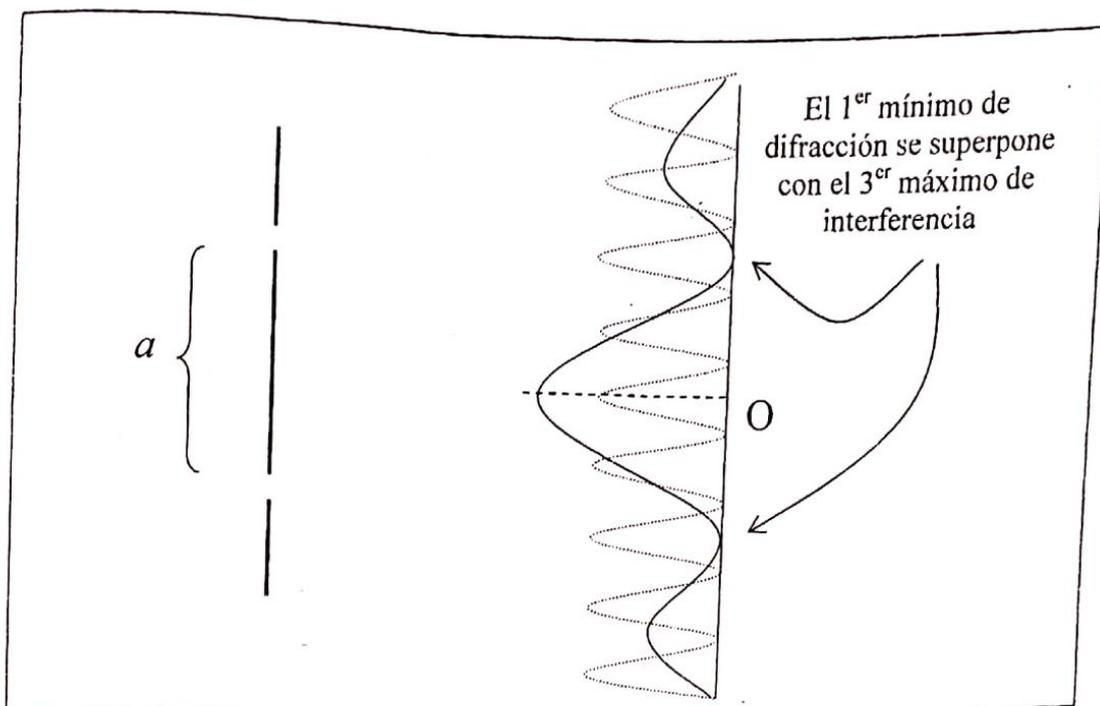
El diagrama resultante (es decir: lo que verdaderamente se ve en pantalla) es el resultado de las franjas de interferencia modulada en la amplitud por el diagrama de difracción. Lo hacemos en el punto (c). Planteamos:
