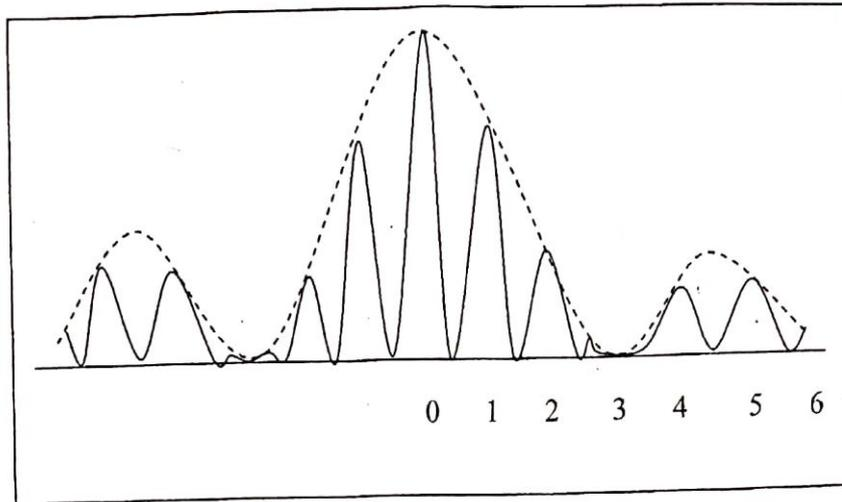
Una pequeña explicación sobre el mismo: los números que figuran debajo corresponden al orden del máximo de interferencia. Como vemos, quedan suprimidos los órdenes 3 y 6. Para hacer el gráfico de la resultante, se moduló en amplitud al gráfico de interferencia, es decir, los máximos de interferencia se estiran o encogen de manera que su altura llega hasta el de difracción (en línea de puntos).
