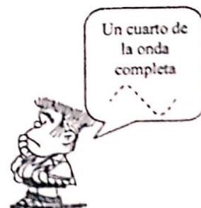
Como vimos en el caso de los tubos cerrados, la distribución de intensidad sigue un esquema como el del dibujo, por lo cual sabemos que la longitud total del tubo es la cuarta parte de la longitud de onda. Por lo tanto, de la medición del largo del tubo averiguo el valor de " $\lambda$ ":
