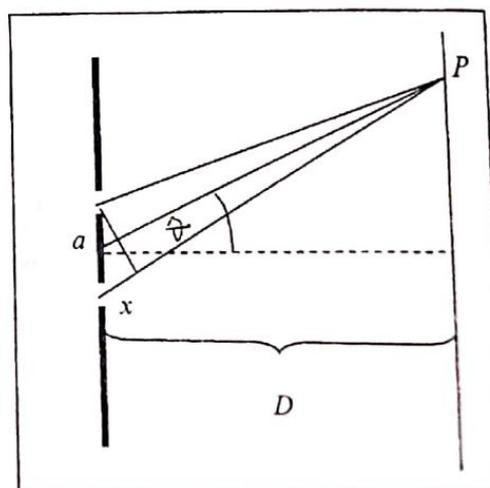
En aquellos puntos de la pantalla *donde la diferencia de camino recorrido por los rayos sea un múltiplo de la longitud de onda  $\lambda$  de la luz usada, la interferencia resultará constructiva.*
