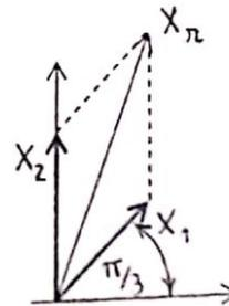
Para obtener la amplitud del MOAS resultante de la superposición, se puede descomponer el  $x_1$  y luego sumar componentes con las de  $x_2$
