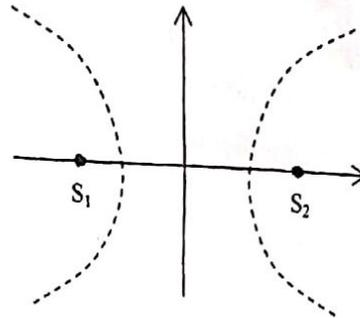
Tomando el centro de coordenadas en el punto medio, las coordenadas del punto  $P$  son  $(x, y)$ . Las posiciones de las fuentes  $S_1$  y  $S_2$  son  $(-0,375 \text{ m}; 0)$  y  $(0,375 \text{ m}; 0)$ .
