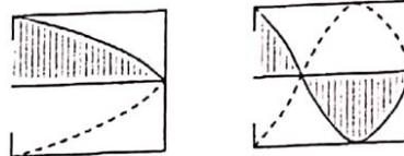
Observar que mientras que para la fundamental la longitud de onda equivale a un cuarto de su longitud de onda, para la armónica siguiente, equivale a tres cuartos de su longitud de onda. Y así como la longitud de onda es la tercera parte, la frecuencia es el triple. Esto es general para los tubos que tienen un extremo cerrado: las frecuencias posibles no son todos los armónicos de la fundamental, sino los múltiplos impares. La expresión de la
